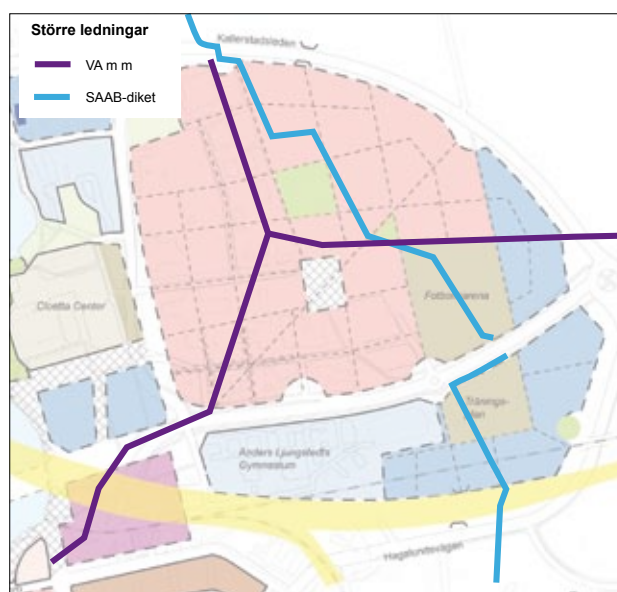
Huvudstråk för avlopp, dagvatten och fjärrvärme i Kallerstad och SAAB-diket.
